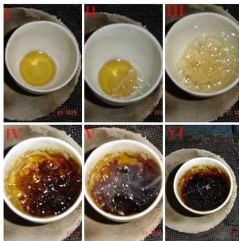
**FIGURA 17: Progressão da reação de carbonização executada em fonte convencional de aquecimento.**
