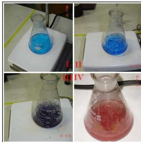
**FIGURA 19: Progressão da reação para determinação de açúcares redutores livres (método de Lane & Eynon).**
